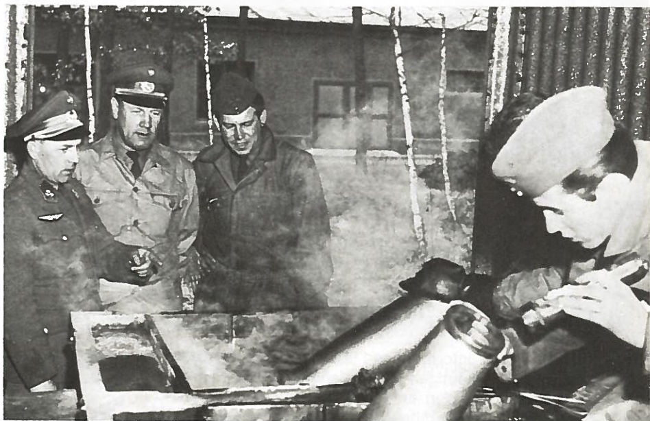
Reinigungsarbeiten an den Triebwerksbrennkammern der Vampire 1962 (Foto: Bildstelle Graz-Thalerhof).
