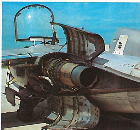
Das Triebwerk der S 105 Generalelectric J 85-21 (Foto Remling).
