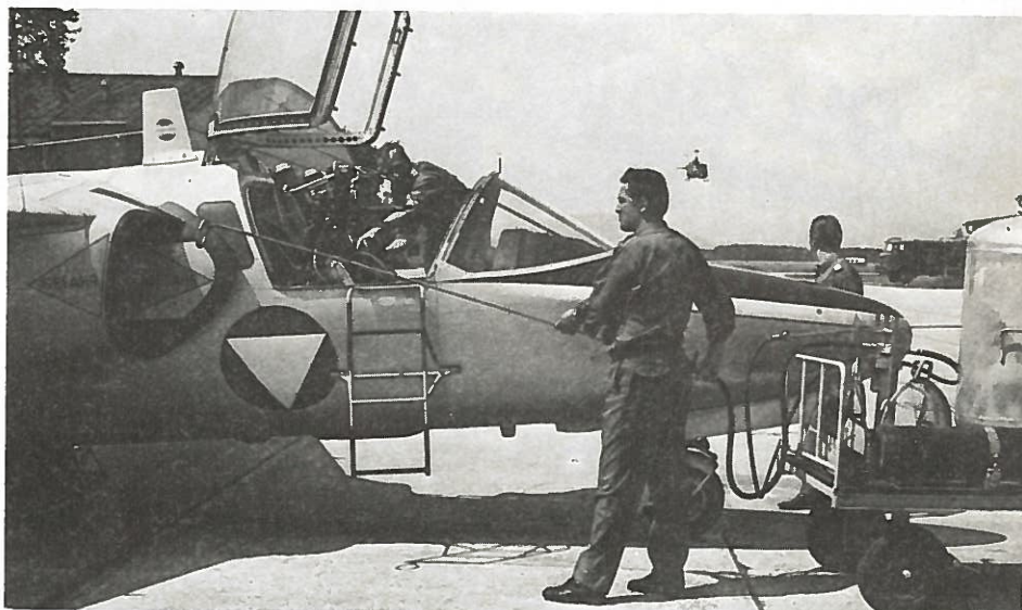
Triebwerkswäsche an der Flight line an einer SAAB 105 Ö 1980 (Foto: Bildstelle Graz-Thalerhof).
