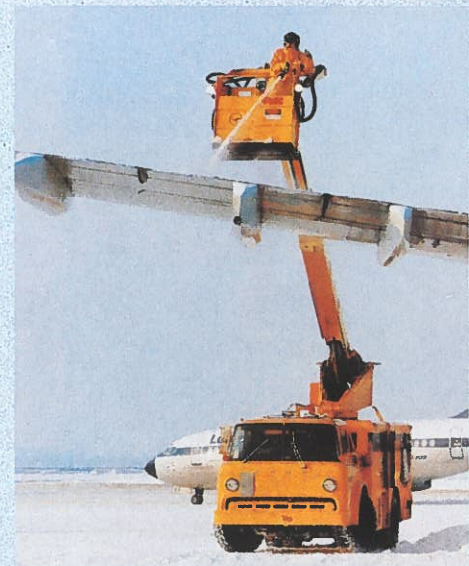
Enteisung der Leitwerke: Garantie für einen sicheren Flug.
